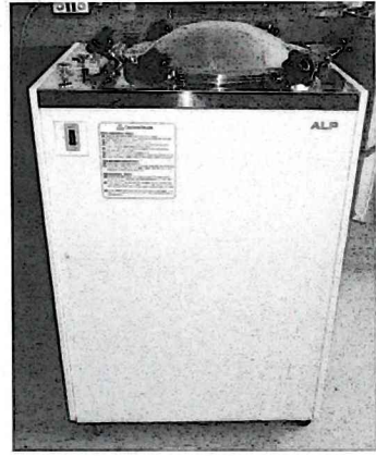
चित्र नं. १: Vertical type अटोक्लेभ
